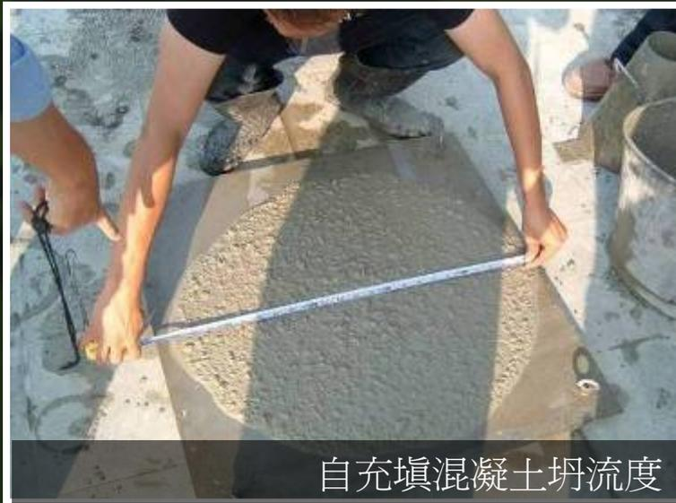
自充填混凝土坍流度
